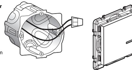
Nutzen Sie eine **Verbindungsklemme**, um die beiden Leitungen zu verbinden.
