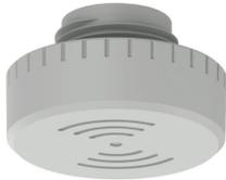
Ein Radarsensor / Mikrowellensensor erfasst die bewegte Masse im Raum. Je größer die Masse, desto höher die Erfassungsreichweite. Der Radarsensor bietet einen horizontal erweiterten Erfassungsbereich. Somit werden beispielsweise Gabelstapler früher erkannt als mit einem PIR-Sensor.
