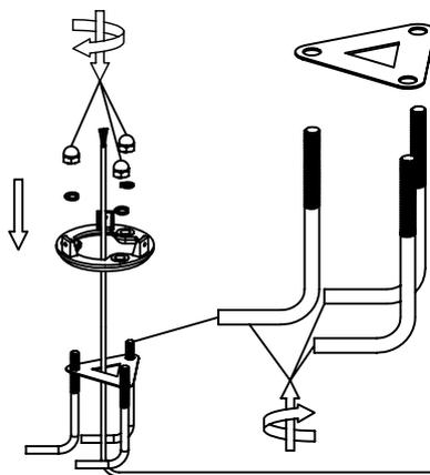
**3.** Verbinden Sie nun das Kabel der Leuchte mit der Verbindungsmuffe und dem Anschlusskabel. Öffnen Sie hierzu die Drehverschlüsse der Verbindungsmuffe und führen Sie die Anschlusskabel hindurch. Schließen Sie daraufhin die Adern an die vorgesehene Klemme an. Dabei ist wichtig darauf zu achten, dass alle Kabel in die richtige Öffnung eingesetzt und sicher festgeschraubt werden.
