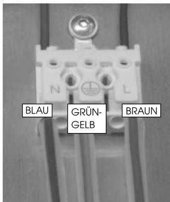
**4.** Schließen Sie daraufhin die drei Kabel an die vorgesehene Klemme in der Leuchte an. Dabei ist wichtig darauf zu achten, dass alle Kabel in die richtige Öffnung geklemmt werden. Links befindet sich der Nullleiter (N), blaues Kabel. In der Mitte befindet sich die Erdung, grün-gelbes Kabel. Rechts befindet sich die Phase (L), braunes oder schwarzes Kabel.
