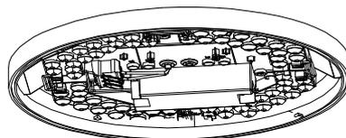
Abdeckung kann mittels Bajonettverschluss geöffnet werden.
