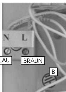
4. Versehen Sie nun alle drei Kabel die in die Leuchte führen mit einem Silikonschlauch aus dem mitgelieferten Montagekit. Die Silikonschläuche schützen die Kabel vor den hohen Temperaturen die in der Leuchte entstehen.
